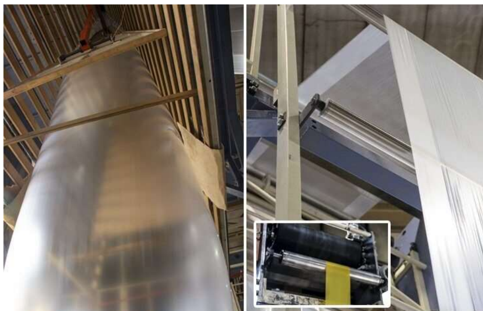
Рисунок 8 Слева — складывающие деревянные щетки формируют полотно, справа — сложенный фальцованный рукав переходит на намоточные валы. На маленькой картинке — натяжные валки
